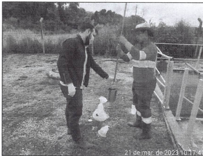
Imagem 01: Detalhe da coleta de esgoto bruto na ETE Rio das Mortes.
